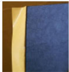
Bitumenpappe wird aus bitumenimprägnierter Wollfilzappe hergestellt. Es ist dauerelastisch, geruchsneutral und gesundheitlich unbedenklich. Geeignet zur Entdröhnung und zusätzlicher Versteifung von Metallteilen im Maschinen- und Anlagenbau, Computerdämmung, Metallteile in Autos, Lärmdämmverstärkung von Schaumstoffen und vieles mehr. Setzt man zwischen zwei Esterabsorber Lärmdämmplatten diese Bitumenpappe, so wird die Lärmdämmwirkung wirksam verstärkt.
