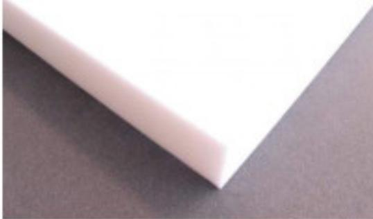
Ethafoam findet vielfältigen Einsatz. Ursprünglich für Verpackungszwecke entwickelt, findet er aufgrund seiner positiven Eigenschaften auch im Bogensport als Zielscheibenuntergrund Verwendung, da sich die Löcher nach dem Eindringen der Pfeile in den Schaum wieder verschließen. Man pinnt einfach ein Stück Papier mit Zielscheibe auf die Platte - fertig. Wir verkaufen Ethfoam direkt ab Werk - egal für welchen Einsatz.
